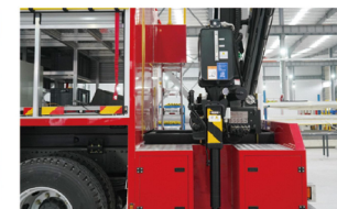
▲ 吊机控制台 Crane Control Panel
